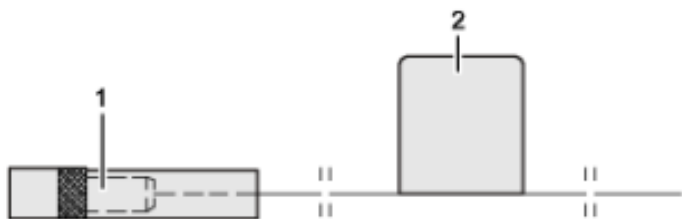
图3-6 75 欧姆时钟电缆外观示意图
